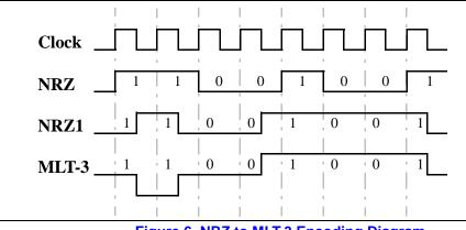
Figure 6. NRZ to MLT-3 Encoding Diagram
